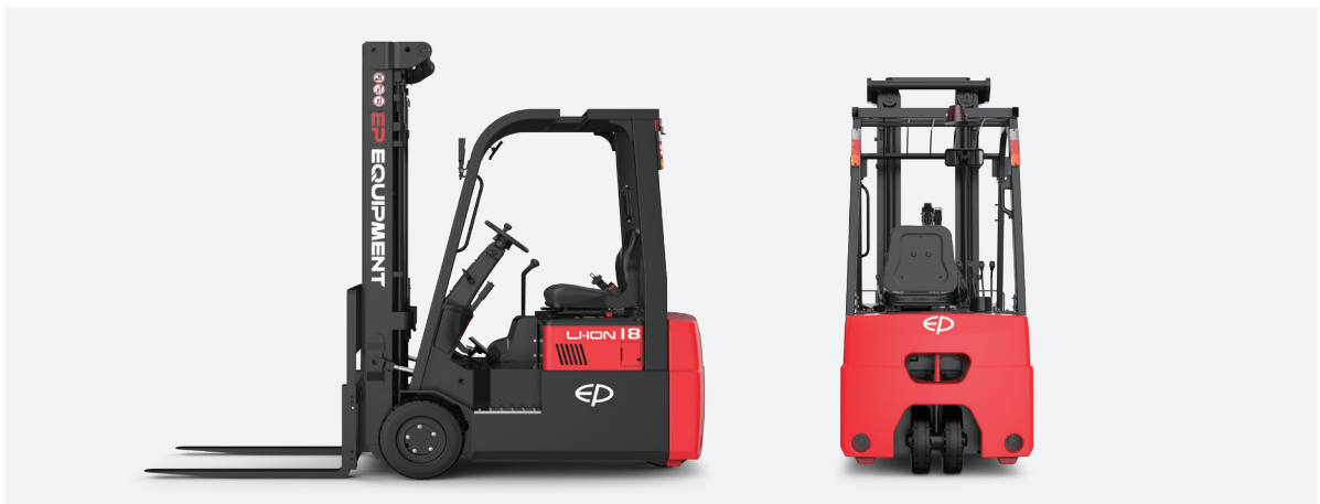
CPD18TVL Longueur jusqu'à la face de la fourche : 1913mm(L2) Largeur hors tout : 1070mm(b1/b2)
